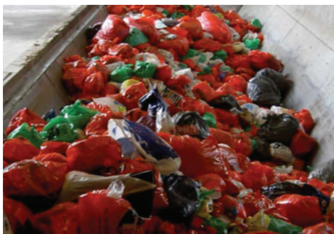
شکل شماره ۳۰: جداسازی نوری کیسه‌های پلاستیکی چندرنگ، کارخانه هضم بی‌هوازی Vänersborg، سوئد
