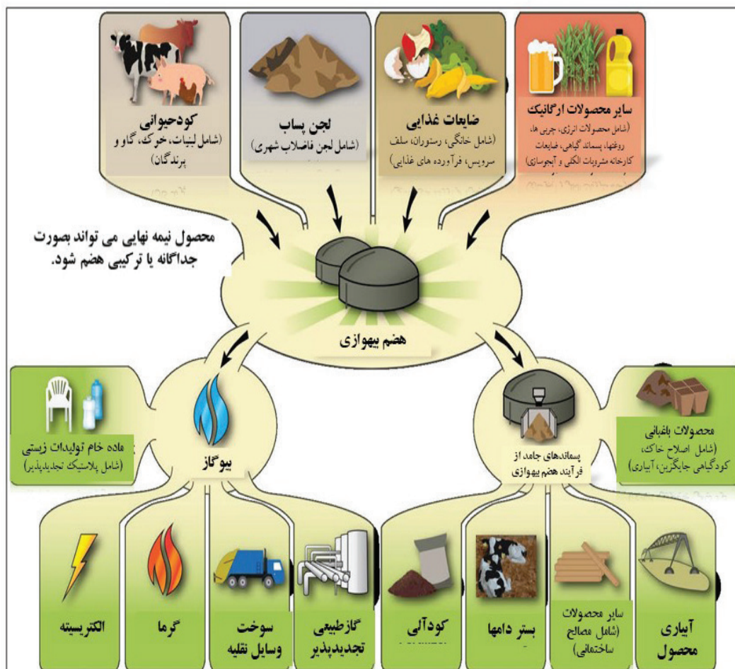
شکل شماره ۸ : نمودار جریان سیستم پایه هضم بی‌هوازی - بیوگاز [۱۱]
